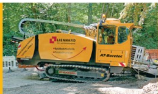
Felsbohranlage 35 to Zug-/Schubkraft
