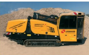
Felsbohranlage 13 to Zug-/Schubkraft
